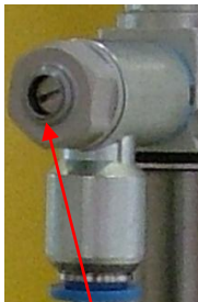
Tornillo de ajuste de un estrangulador de escape
