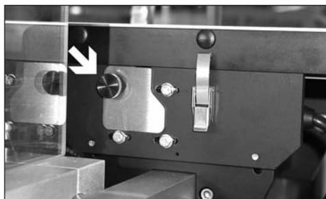
III. 9: Tôle de la courroie crantée
