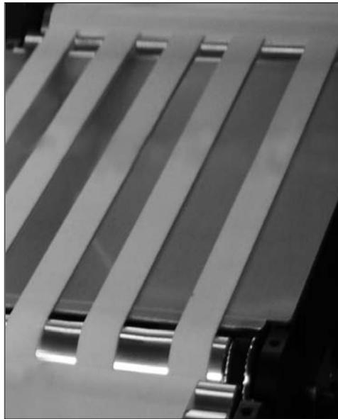
Sur le **modèle C**, la plate-forme de pesage dynamique de la taille 2 est équipée de bandes élastiques (option D15). Le convoyeur de pesage est déjà complètement monté.
