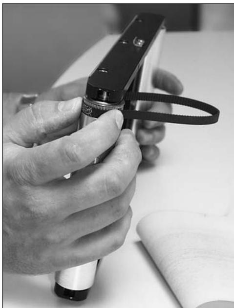
III. 32: Remplacer la courroie crantée
