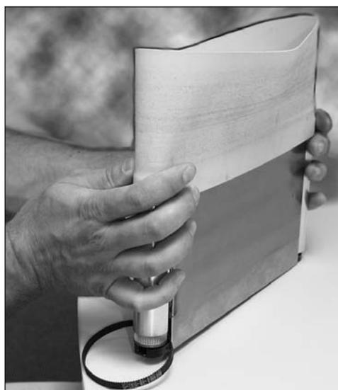
III. 25: Déposer la bande transporteuse
