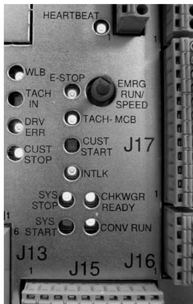
Le bouton bleu placé à côté du marquage **EMRG RUN/SPEED** est un régulateur de vitesse avec interrupteur intégré pour la marche d'urgence.
