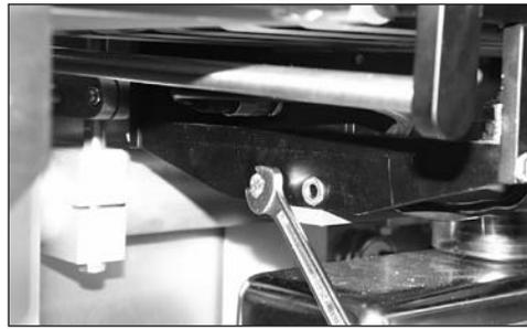
4. Visser le support du convoyeur des deux côtés par les alésages du support du convoyeur au moyen des quatre vis hexagonales M6 sur la traverse de la cellule de pesage.
