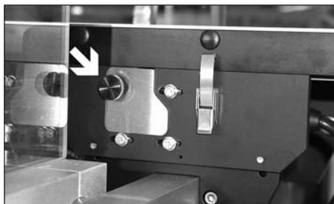
III. 30: Vis moletée de la tôle de protection de la courroie crantée
