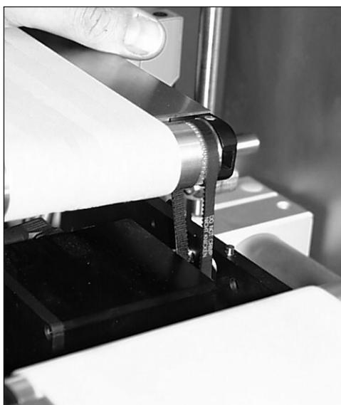
III. 22: Déposer le convoyeur de transport
