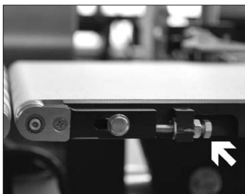
III. 18: Régler la tension de la bande et la stabilité directionnelle
