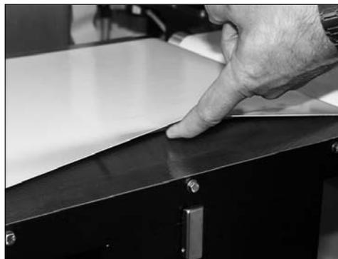
III. 14: Tension suffisante de la bande (règle du doigt)
