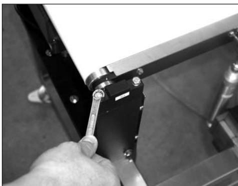
III. 14: Vis de la partie supérieure du support du convoyeur
