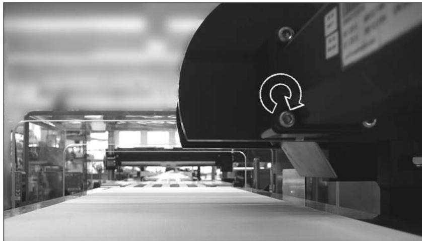
III. 46: Vue latérale de la roue à ailettes d'éjection, palette de tri en position de repos (vu depuis le côté sortie)
