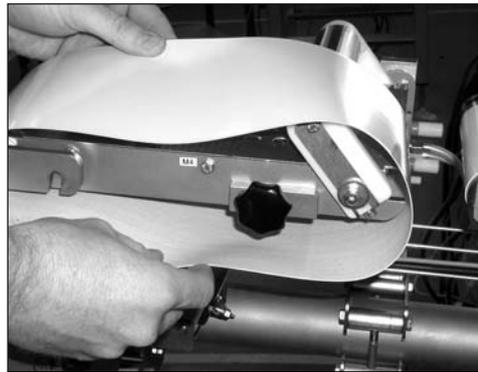
III. 26: Remplacer la bande transporteuse
