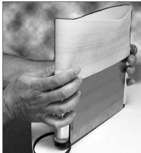
III. 18: Déposer la bande transporteuse
