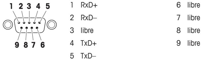
**Interface RS422A** D-Sub, à 9 pôles (broches). Contre-connecteur adapté: D-Sub9 (douilles)
